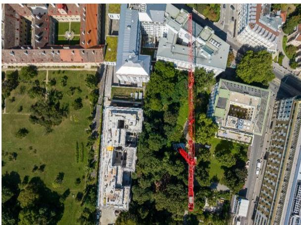
Dank dieser Spitzenleistung kann er sämtliche Baumaterialien und Fertigbauteile zwischen Prätoriusgasse (im Bild rechts) und Baustelle transportieren, sodass kaum Baufahrzeuge durch den botanischen Garten fahren müssen. Auch die Montage fand von der Prätoriusgasse aus statt.
